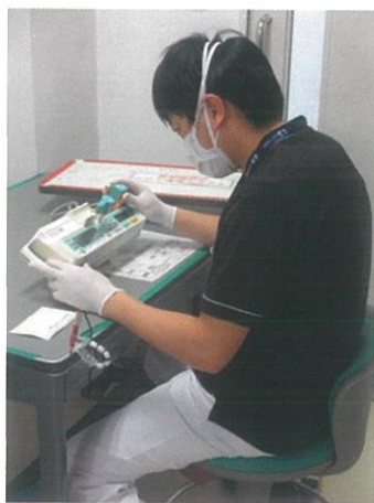
シリンジポンプ点検作業中
