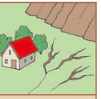
地面にひび割れができる
