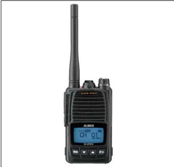
出力はパワフルな5W、意外によく飛ぶ2W、電池の持ちが良い1Wの切り替え式。
