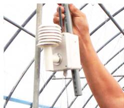
自作の温湿度センサー。ハウス内の温度や湿度、CO2濃度を測定し、スマートフォンで確認が可能。
