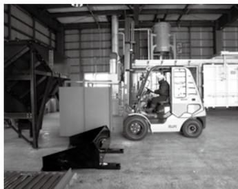
破碎されたごみを炭化炉へ運びます。炉内を真空にし約23時間かけて処理します。
