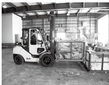
収集された『炭にできるごみ』は、破碎機へ運びます。破碎機でごみがある程度小さく破碎します。
