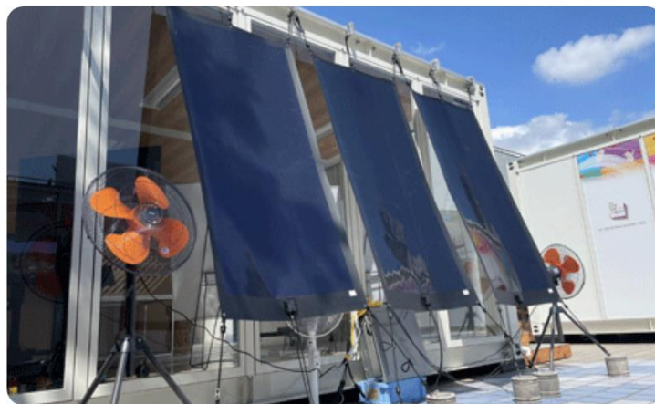
「G7広島サミット2023」会場にて展示されたフィルム型ペロブスカイト太陽電池 （出典）積水化学工業株式会社
